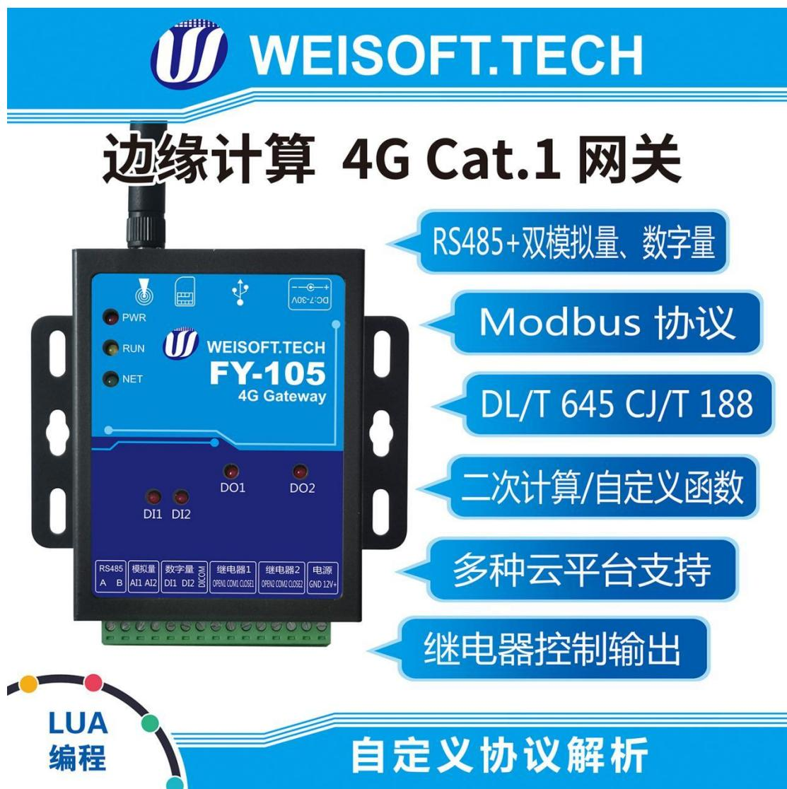
FY-105 接口端子：485(A+,B-)，模拟量(AI1,AI2)，数字量(DI1,DI2,DICOM)，继电器1(常开,COM,常闭)，继电器2(常开,COM,常闭)，电源(GND,12V)
