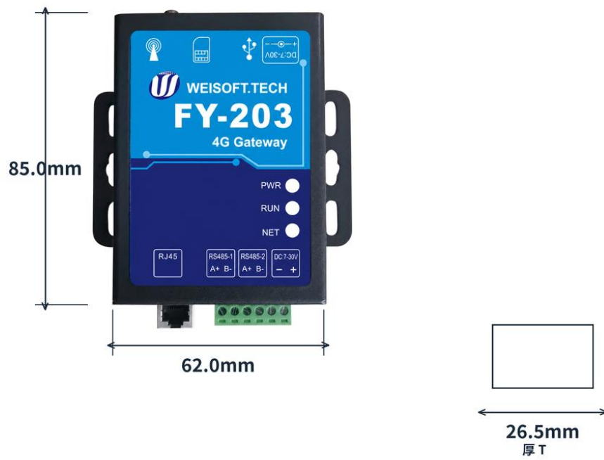
FY-203：尺寸为外壳尺寸（长×宽×厚），不含端子与天线；宽为外壳底边；单位：mm
